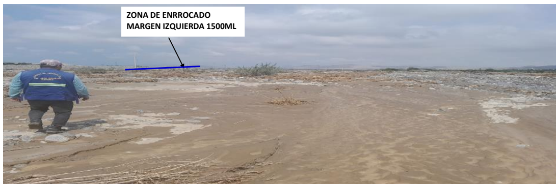
FIGURA N°01: tramo crítico en el RÍO SAMANCO (RÍO NEPEÑA), en el sector Huambacho la Huaca y Huambacho el Arenal, Distrito de Samanco, Provincia del Santa - Ancash. La meta física consta de la limpieza y descolmatación en el Tramo en mencion, conformación de dique con material propio en ambas márgenes y enrocado en la margen derecha y en la margen izquierda.
